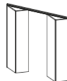
DOUBLE BIFOLD DOOR / SULANKSTOMOS dvigubos DURYS 3-sided frame for double 2-leaf door panels (3-ijų pusių rėmas)
